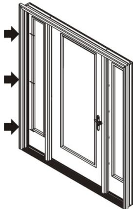
Ajuste la jamba de la bisagra de la vidriera lateral en el lado del listón con bisagras del módulo para que los burletes hagan contacto de forma pareja desde la parte superior a la parte inferior del lado de la cerradura de la vidriera lateral. Pase un tornillo a través de la jamba del lado con bisagras hasta el montante, en cada ubicación de las bisagras restantes.
