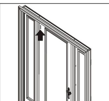
Use un nivel de 6 pies y coloque a plomo el entrepaño del lado con bisagras de dos maneras (de derecha a izquierda y del interior al exterior).
