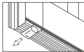
Su módulo para puerta tiene cubiertas para umbral ajustables. Cuando se ajustan correctamente, deben quedar apretadas y debe ser ligeramente difícil jalar un billete de un dólar por debajo de la puerta y las vidrieras laterales cuando están bien cerradas. Se debe poder retirar el billete de un dólar sin rasgarlo.
