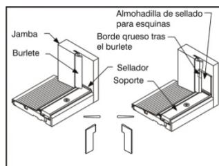
Aplique el sellador (elastomérico o de poliuretano) en la unión donde la cubierta para umbral se une con las jambas y los listones verticales.
