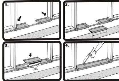
**Nota:** Use sólo el cemento PVC incluido en el kit de revestimiento para alféizar para unir las piezas. El revestimiento para alféizar se debe sellar al subsuelo usando un sellador elastomérico o de poliuretano, pero no aplique sellador a la parte inferior del alféizar cuando use un revestimiento para alféizar.
