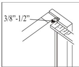
Ajuste el listón vertical del lado de la cerradura de manera que los burletes hagan contacto con la superficie de la puerta de forma pareja en la parte superior, la parte del medio y la parte inferior a unos 0,95 a 1,27 cm cuando la puerta esté completamente cerrada. Coloque un tornillo en el orificio taladrado previamente en la jamba del cabezal, en el entrepaño del lado de la cerradura.
