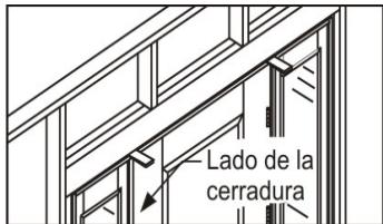
Coloque calzas directamente en el listón vertical del lado de la cerradura. Vuelva a revisar el listón vertical del lado de la cerradura para asegurarse de que los burletes estén en contacto de forma pareja desde la parte superior a la parte inferior. Termine de apretar el tornillo.
