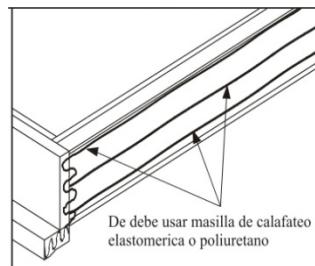
Coloque el módulo para puerta sobre su borde o frente, de manera que se pueda calafatear la superficie inferior del alféizar. Coloque cordones muy grandes de masilla de calafateo a lo largo de todo el ancho del alféizar. Además, coloque cordones de masilla de calafateo a lo largo de la unión del alféizar y la jamba y en la superficie inferior de las jambas y las molduras de ladrillo.
