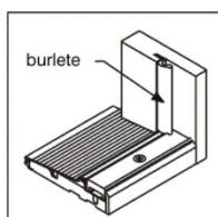
Después de ajustar la cubierta para umbral, asegúrese de que el burlete esté al ras con la parte superior de la cubierta para umbral. Corte si es necesario.
