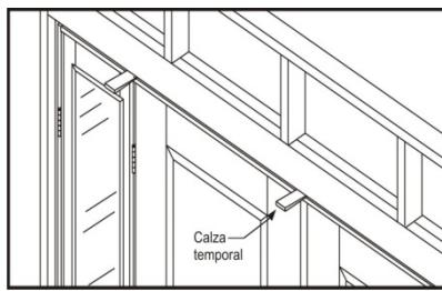
Cuando instale una puerta estilo francés con vidrieras laterales activas, coloque calzas temporales sobre el centro del marco del cabezal donde se unen las puertas. Taladre previamente e inserte un tornillo a través del marco en el dintel y luego retire las calzas temporales.
