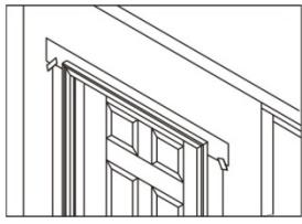
Proporcione y mantenga una cubierta de goteo o un tapajuntas de dintel instalados de forma adecuada para proteger la parte superior de las superficies del ingreso de agua y del daño. Coloque cinta adhesiva y selle de manera adecuada la parte superior de la lengüeta de la barrera resistente al agua (WRB) sobre el tapajuntas del dintel.
