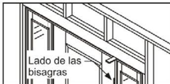
Coloque calzas directamente en el listón vertical del lado con bisagras. Con un nivel de 6 pies, vuelva a revisar el listón vertical con bisagras para asegurarse de que está a plomo y recto. Termine de apretar el tornillo.
