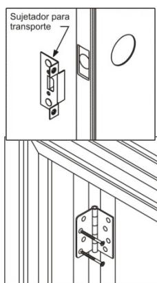
Retire los sujetadores para transporte. Verifique que la puerta y las vidrieras laterales funcionen correctamente.
