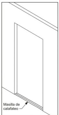
Coloque 3 cordones muy grandes de sellador en el subsuelo de la abertura. Extienda los cordones hasta alcanzar el ancho total de la abertura.
